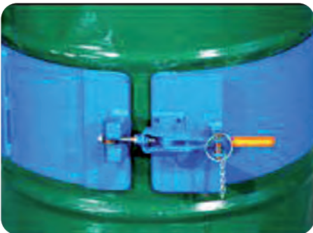
Sistema di presa a collare
